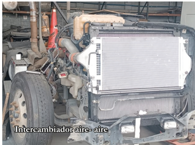
Figura 28. Ubicación del intercambiador de calor tipo aire-aire. Elaborado por el autor.
