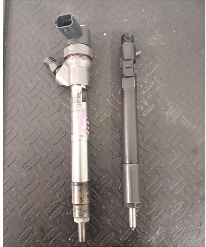
Figura 35. Inyector controlado electrónicamente para motor diésel. Elaborado por el autor.
