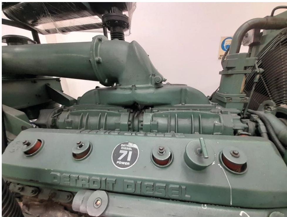
Figura 25. Sistema de doble compresor tipo volumétrico. Elaborado por el autor.
