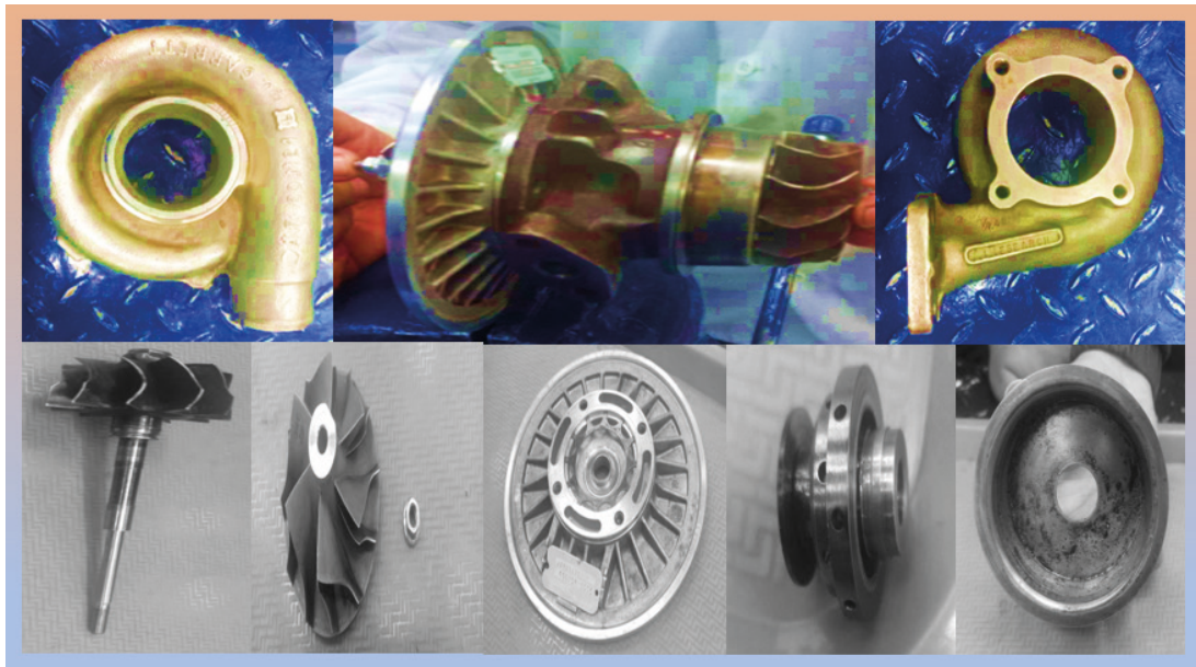
Figura 24. Componentes compresor tipo centrífugo. Adaptado de The Daily Drive.
