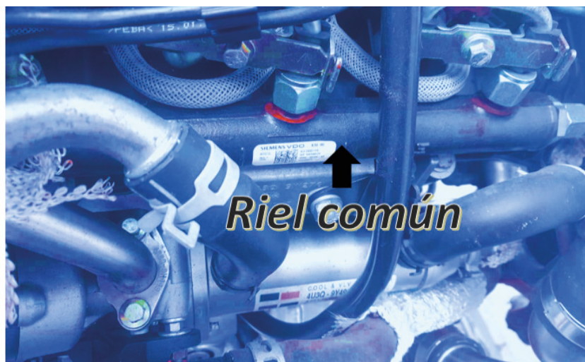
Figura 34. Riel de inyección de alta presión. Elaborado por el autor.
