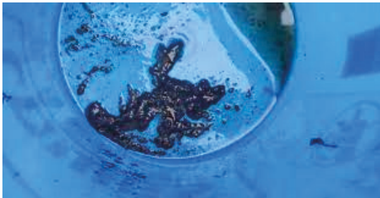
Figura 15. Contaminación en el combustible diésel. Fondear
