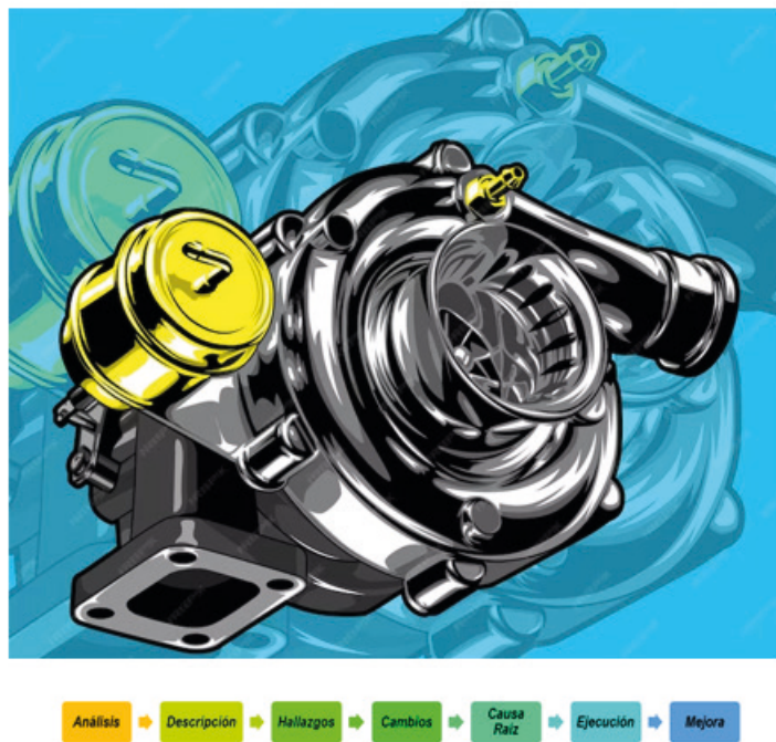
Figura 20. Pasos para diagnosticar fallo en un turbo compresor. Cummins
