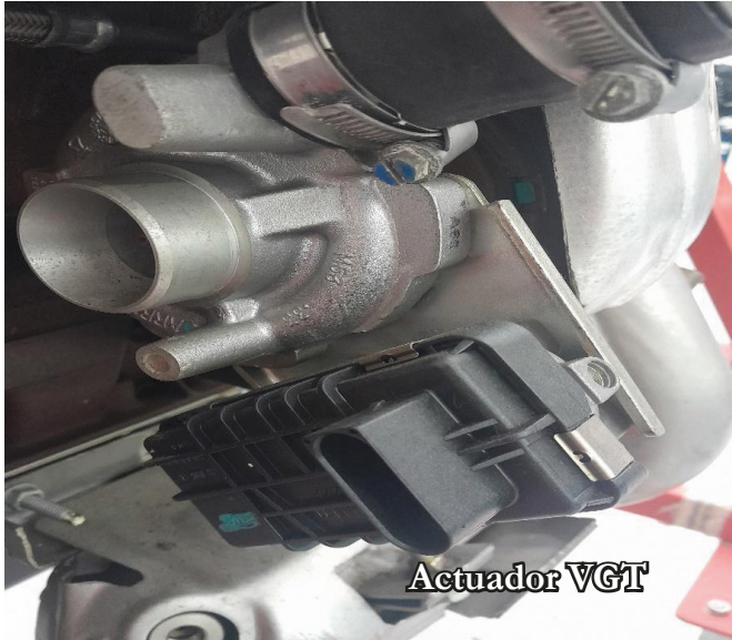
Figura 27. Turbo con actuador electrónico para regulación de geometría variable. Elaborado por el autor.
