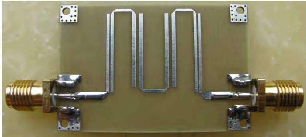
Figura No. 7.43 Filtro paso banda microstrip en 2.4 GHz.
