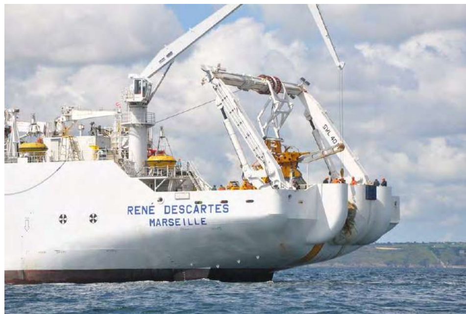
Figura No. 9.26 Sistema de tendido o recuperación del cable.
