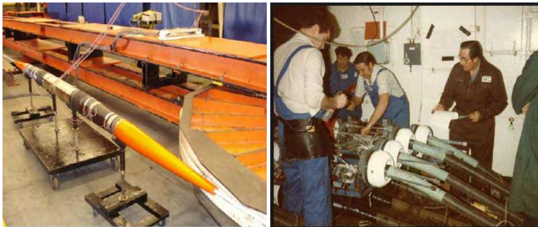
Figura No. 9.28 onas de empalme en un barco cableo.
