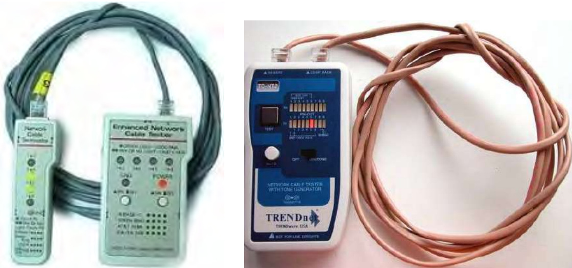
Figura No. 4.12 Tester de red conectado a un cable par trenzado.
