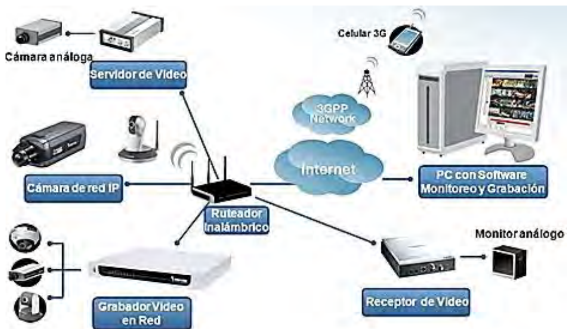
Figura No. 5.61 Esquema simplificado de la conformación de una red de CCT para un área amplia.
