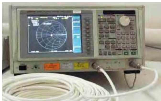
Figura No. 5.5 Medidor de atenuación de los cables coaxiales.
