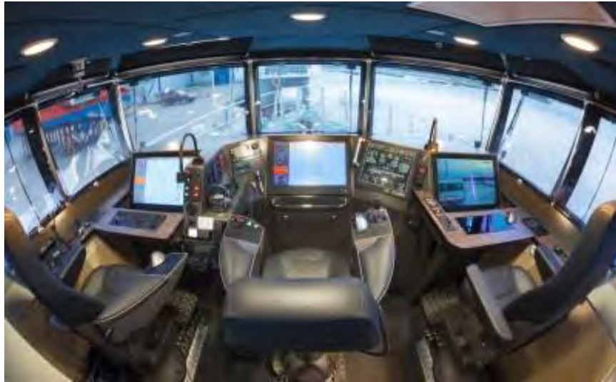
Figura No. 9.29 Puesto de comando de un barco cablero.
