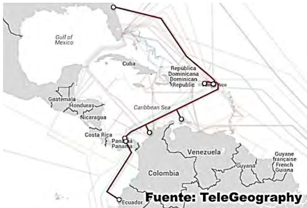
Figura No. 9.55 Configuración del tendido de la red del cable óptico submarino: PCCS.
