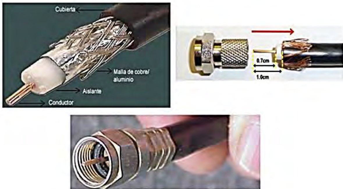
Figura No. 5.70 Proceso de colocación del conector al cable coaxial.
