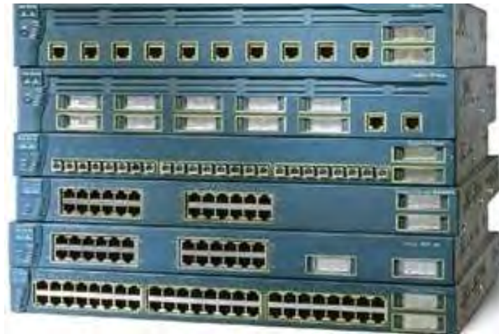
Figura No. 4.29 Switches Catalys 3550 de 48 puertos.
