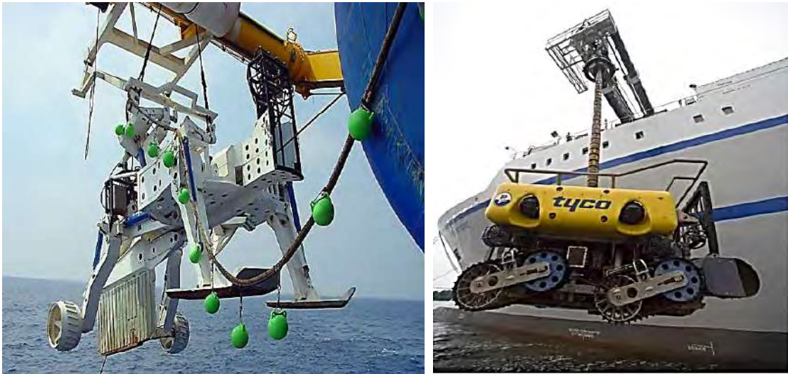
Figura No.5.49 Imágenes de robotsumergibleempleadosparalainstalación de redes submarinas.
