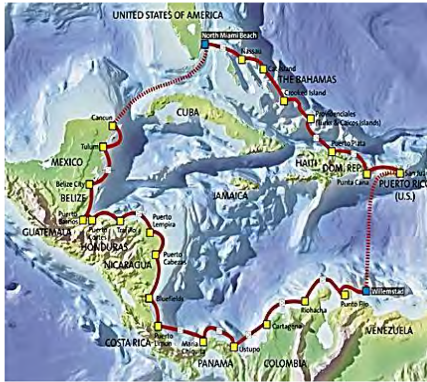
Figura No. 9.48 Configuración del tendido de la red del cable óptico submarino: ARCOS-1.
