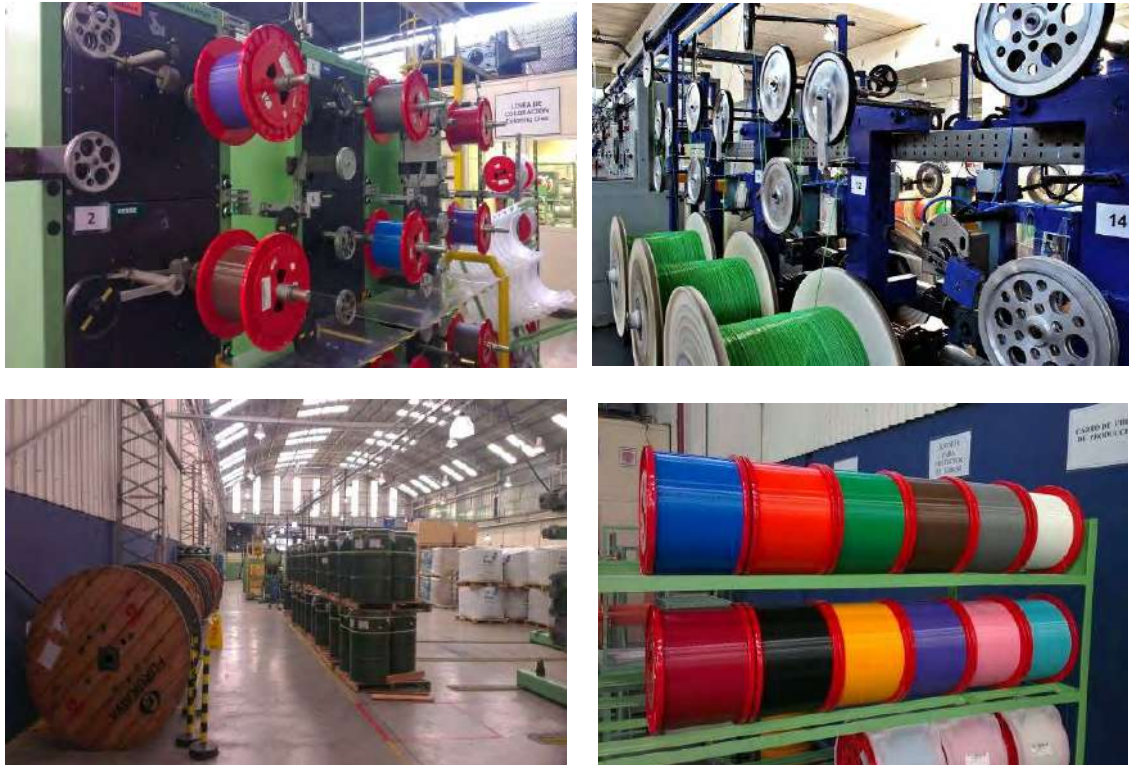
Figura No. 8.48 Procesos de enrollado de la fibra óptica y almacenamiento de los carretes correspondientes.
