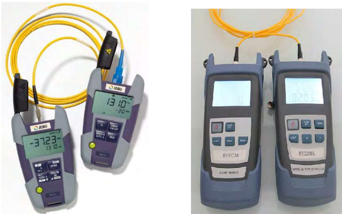
Figura No. 8.59 Sets de medidores de potencia óptica OLTs.
