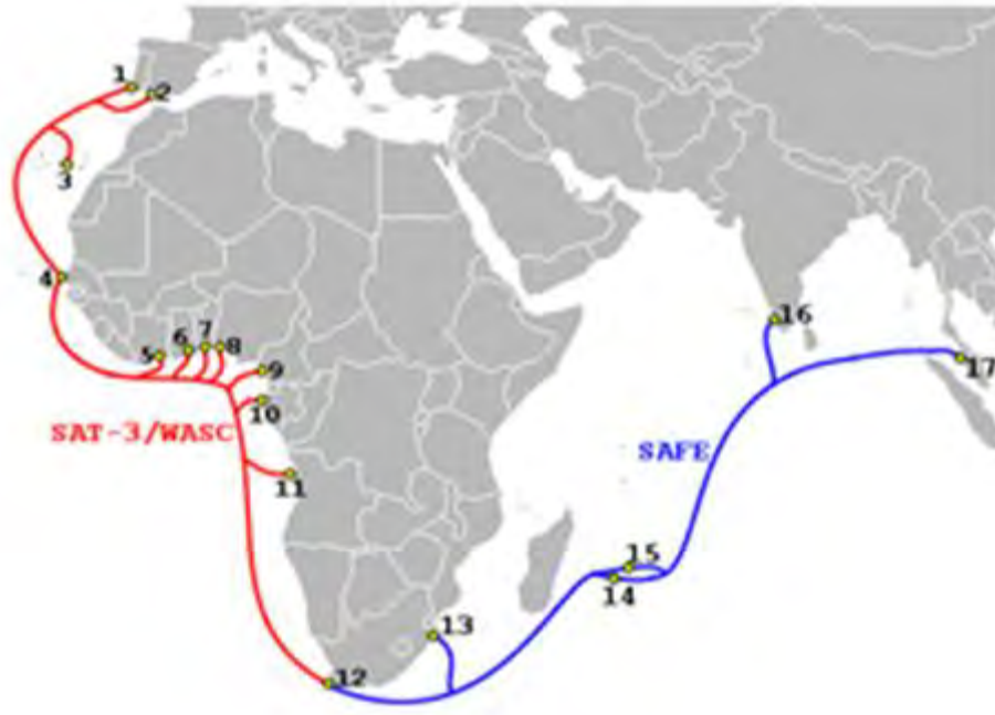
Figura No. 9.50 Configuración del tendido de la red del cable óptico submarino: SAT-3/WASC SAFE.
