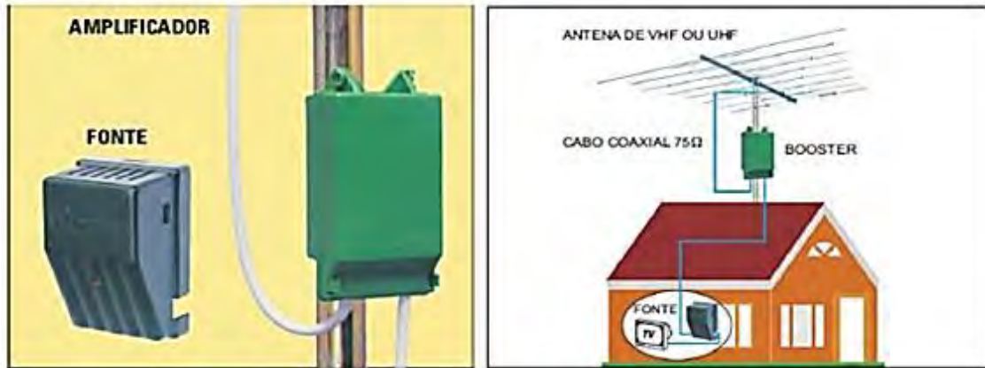
Figura No. 5.9 Instalación individual con amplificador de mástil.
