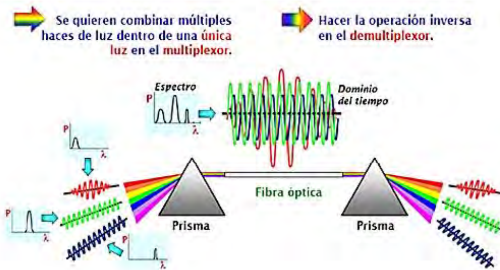
Figura No. 10.36 Concepto básico de la multiplexación demultiplexación óptica.
