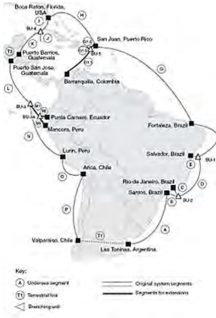
Figura No. 9.46 Configuración del tendido de la red del cable óptico submarino: SAM-1.
