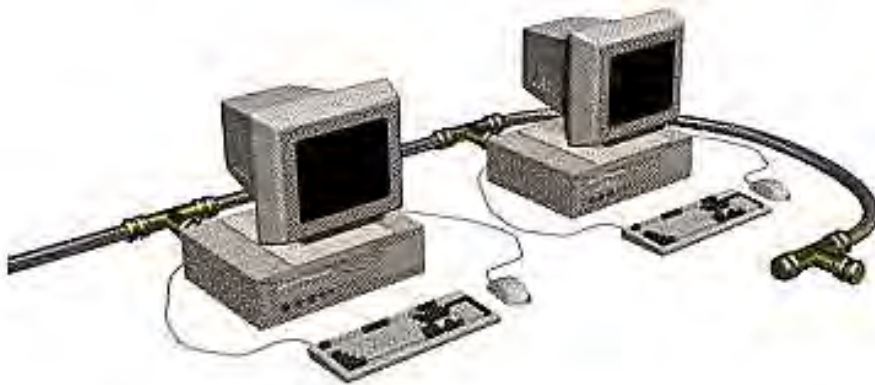
Figura No. 5.37 Conexión de dos terminales de una red de transmisión de datos en topología de Bus.
