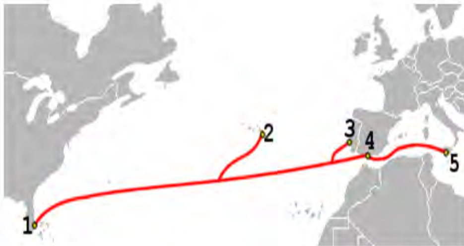
Figura No. 9.44 Configuración del tendido de la red del cable óptico submarino: COLUMBUS III.
