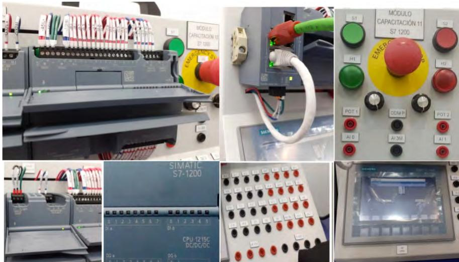
Figura 6.3: Componentes del Controlador Industrial S7-1200 Instalado en el Banco de Trabajo de la Universidad ECCI.
