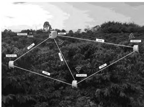
Figura 13 Topología lógica y física de la red de sensores inalámbricos (WSN) (Fuente: Autor)
