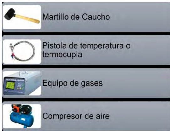
Figura 12 Materiales y equipo de prueba de motor
