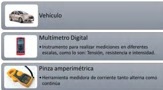
Figura 4 Materiales y equipo - Prueba de Fuentes.
