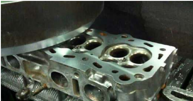
Figura 54: Equipo de rectificación horizontal. Recsel Motors.
