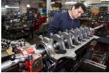
Figura 66: Rectificación de bancada bloque motor. Rectificadora de motores Badilla.
