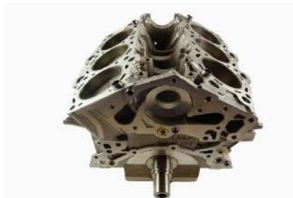
Figura 59: Bloque de cilindros en V. Las palmas tecnología.
