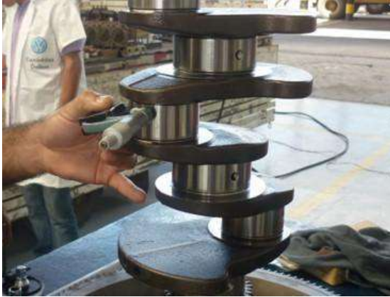
Figura 72: Medición muñón cigüeñal. Cummins motor company.
