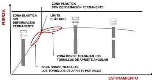
Figura 10: Zona plástica y elástica. Ajusa.es.
