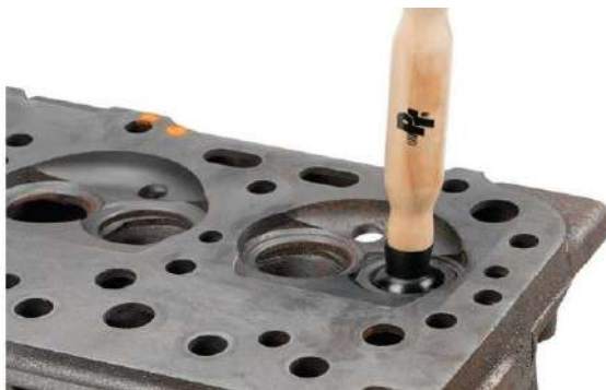
Figura 58:Asentamiento manual de válvulas. Mercado libre.
