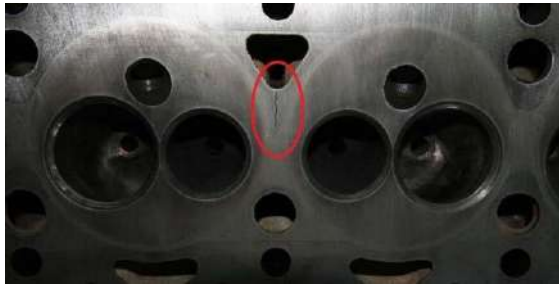
Figura 52: Prueba hidrostática. Comec.
