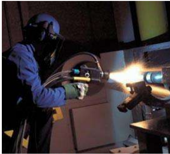
Figura 35: Rociado térmico en el eje de levas. Metaljet.
