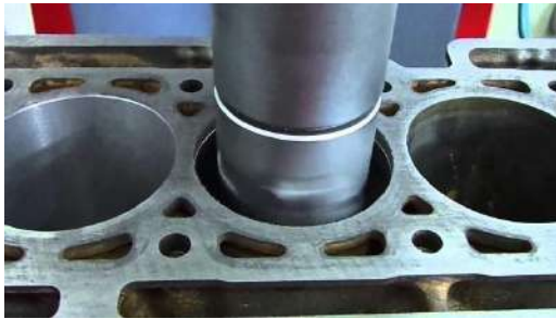
Figura 65: Rectificación de bancada bloque motor. Rectificadora de motores Badilla.
