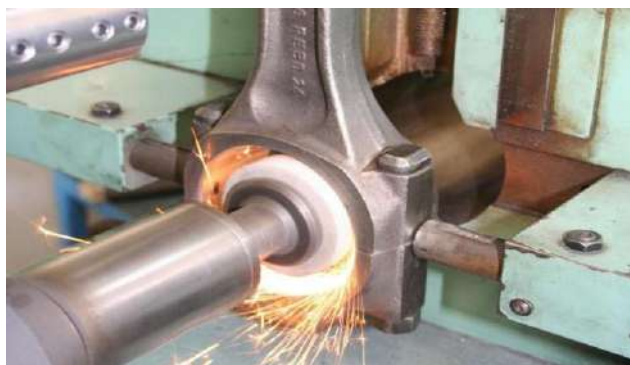
Figura 88: Rectificación de círculo de biela. Cserrano.
