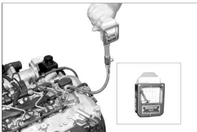
Figura 22: Toma de compresión. Ssangyong motor company.
