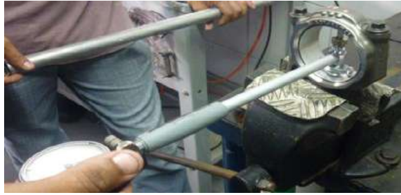
Figura 85: Verificación ovalización de la cabeza de la biela. Cummins motor company.
