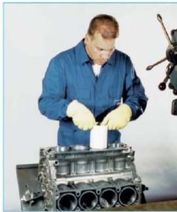
Figura 63: Montaje de camisa de cilindro por contracción. Motor service international.
