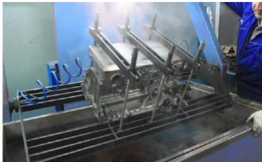
Figura 68: Prueba hidrostática en bloque de cilindros. Comeca.
