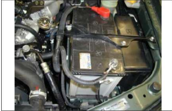
Figura 5: Desconexión de la batería. Isuzu motor company.
