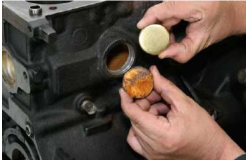
Figura 67: Cubiertas del sistema de refrigeración en el bloque de cilindros. Auto images and specifications.
