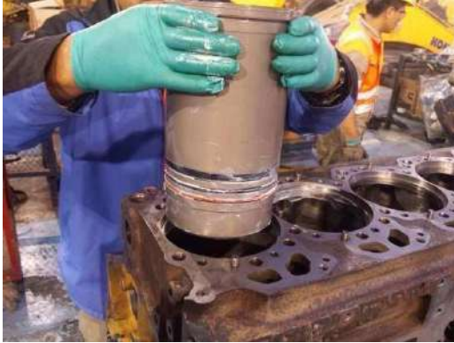
Figura 64: Instalación de camisa de cilindro del tipo húmeda. Docplayer.es.
