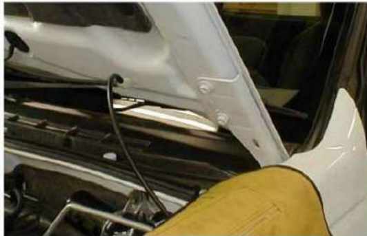
Figura 6: Desmontaje del capó. Isuzu motor company.
