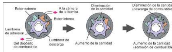
Figura 2.8: Funcionamiento bomba de alimentación tipo trocoide. Denso
