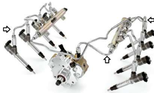
Figura 2.10: CTuberías de impulsión. Karla.ee
