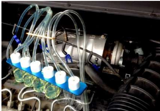
Figura 2.14: Comprobación retorno de combustible. Autoavance
