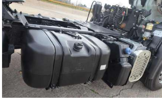
Figura 2.4: Depósito de combustible. Truckmagazine
